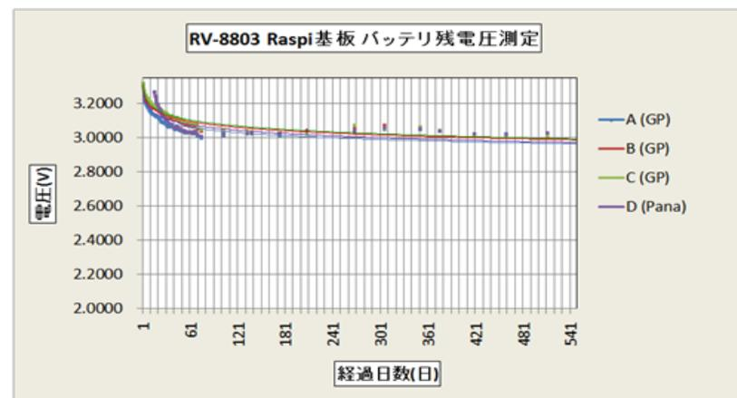
(RV8803-Raspi基板 / CR1025電池での時計保持動作時の電池残存電圧の実測)
