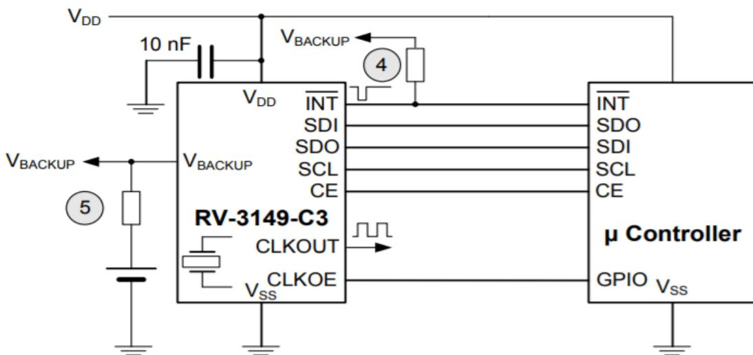
④ <RV-3149-C3> を 2重層コンデンサやリチウム電池などのバックアップ電源を用いて使用する
