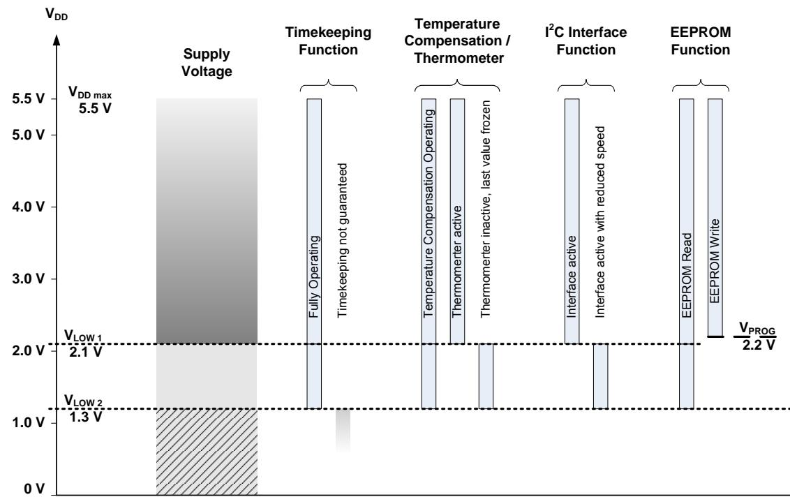
最初の電源投入時には正しくデバイスを設定するために $V_{DD}$ 電圧は  $V_{LOW1}$  (=2.1V) を上回る必要があります。
