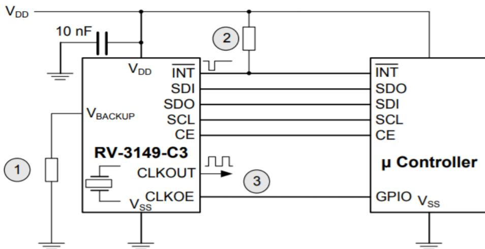
① <RV-3149-C3> をバックアップ電源無しで使用する場合には、 $V_{BACKUP}$ 端子(#8ピン)と
