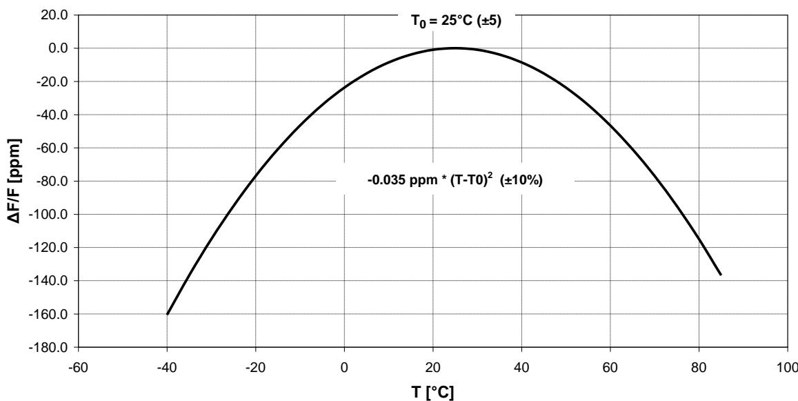
32.768KHz音叉型水晶振動子の周波数温度特性の例です。
